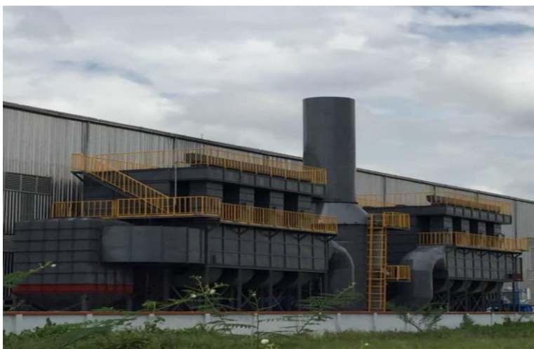
图 7.2.2-5 本项目熔炼废气处理装置示意图
