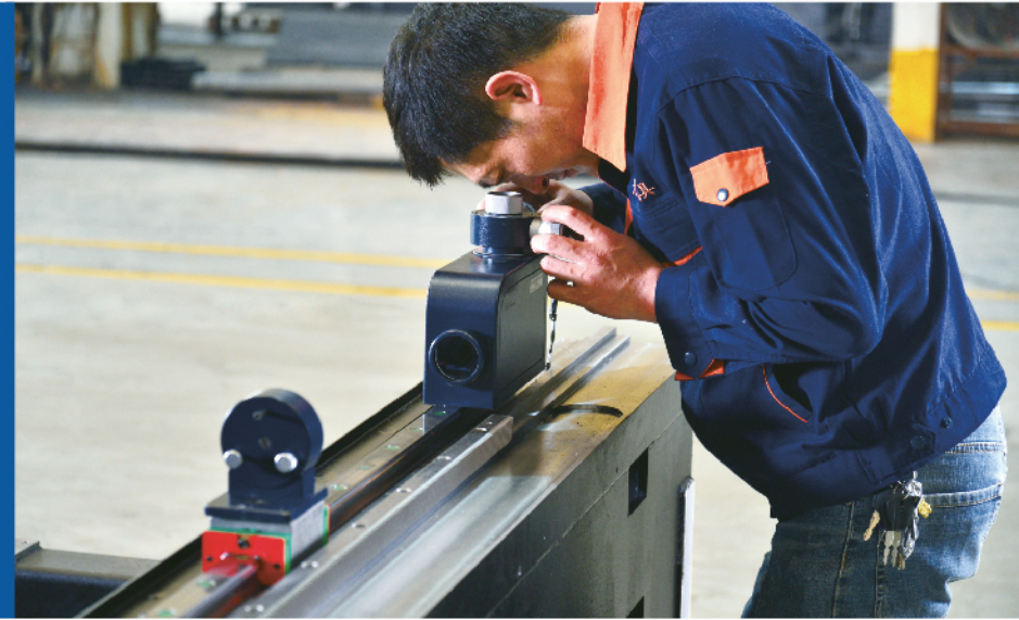
准直仪检查导轨精度
