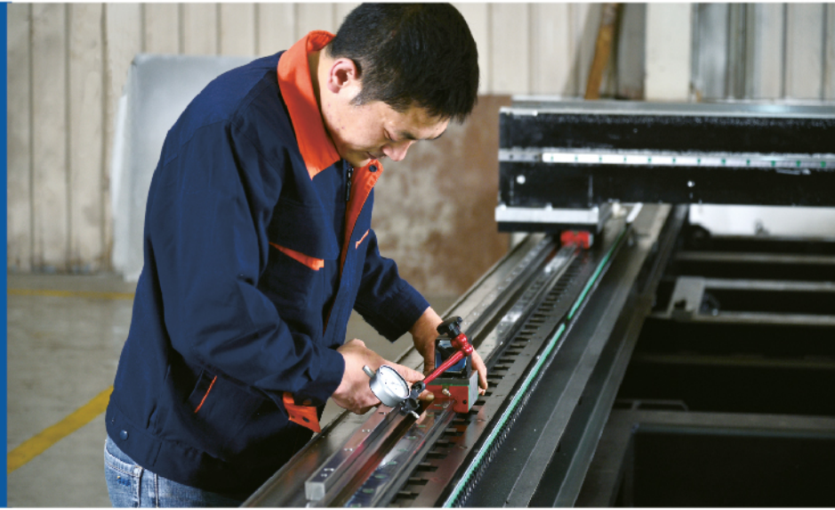
千分表检测圆条精度
