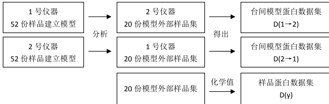
图 3：获取仪器台间差异数据流程
