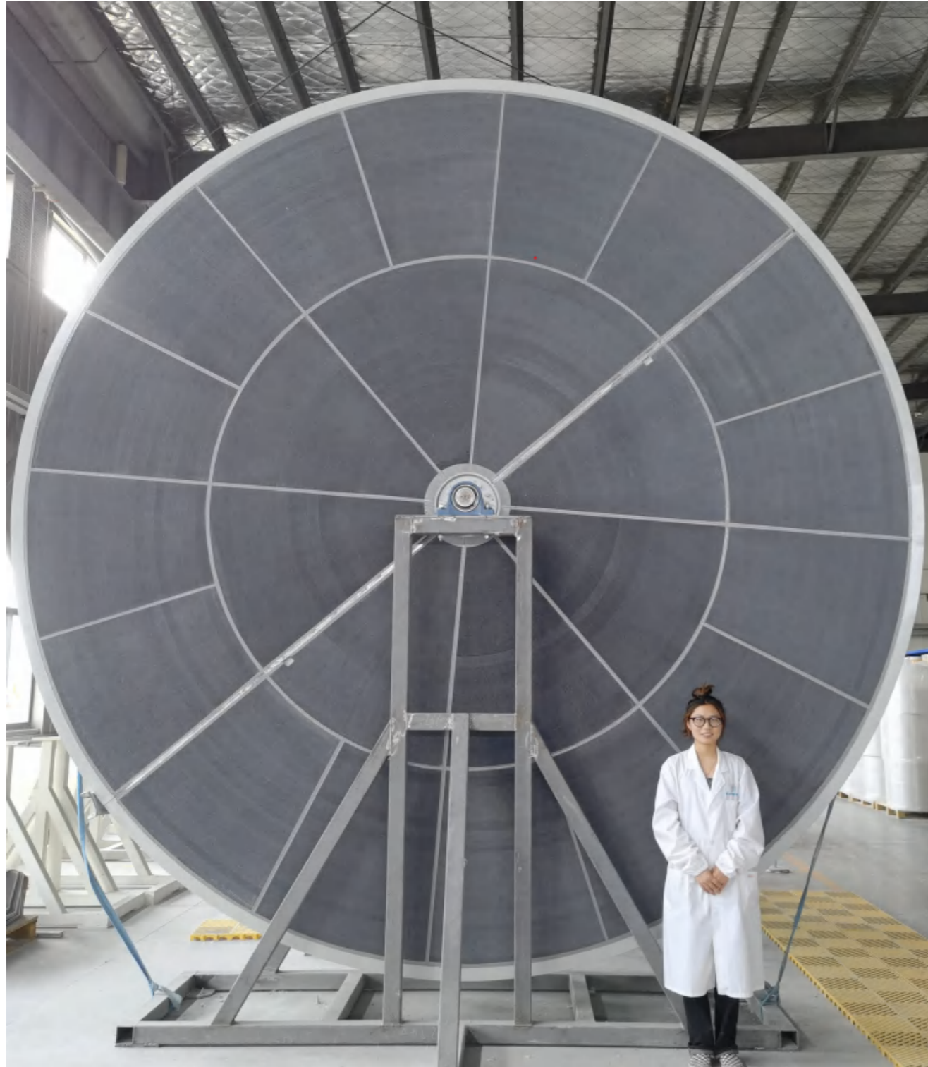
转轮规格 (直径4500mm)
