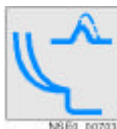
系统保护用断路器, TM、LI 功能 带可调整定值的热过载脱扣器, 固定整定值的短路脱扣器
