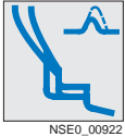
系统和发电机保护用 - ETU20, LSI 功能 时基选择性保护 (S 功能: I_{sd} = 1.5 - 10 \times I_R , t_{sd} = 0 - 0.5 s)
