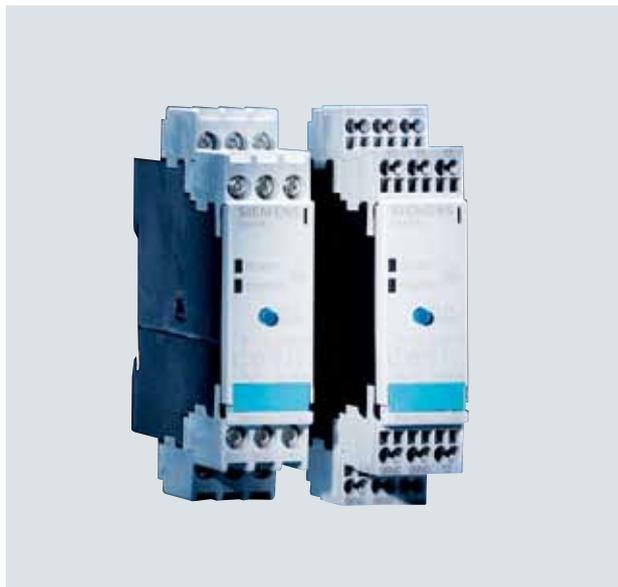
当使用断路器或者过载保护继电器进行电流保护都不理想时，热敏电阻电机保护继电器显示出其独特的优势。在某些情况下，由于外部影响，发生的过热现象不能通过断路器或过载继电器检测出来。例如重载启动（如离心机），变频运行、制动，以及由于污垢而造成冷却受限的情况。
