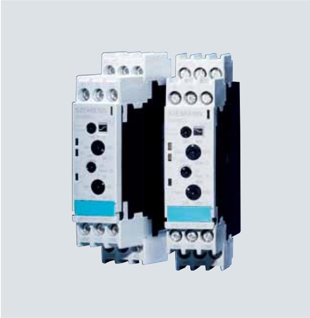
3RS10/3RS11 温度监控继电器是一种模拟继电器，用于测量固体、液体和气体介质的温度。通过放在介质内部的一个传感器来测量温度，经分析单元计算出温度值，并监控其是否在温度的上下限之内。根据已设置的参数，判断是否可在其阈值上开合。
