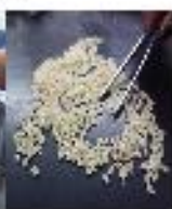
称样本 20g 用筛米筛出糙米 筛出米粒检测糙米率
