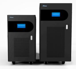
Neptune(海王星)系列包括三进单出GM8K-GM100K,可8台直接并机,方便快捷。灵活的并机技术可适用于不同负载及系统,按客户的需求构成N+1或N+X工作架构,还能根据客户的不同需求,进行不同容量的随意8台并机,由并联冗余系统中全部UPS来平均负担系统负载,并联冗余系统中任何一台UPS发生故障,其余UPS立即分担其负载,确保系统正常运行。并且在并机过程中,并不用特意设定主机备机,而是灵活的随客户选定,首先开通的机器自动设定为主机,当主机出现系统故障时,主机身份即时转移到另一台机器上去,从而保证了客户在使用过程中的电力供应,成为真正的不间断电源。
