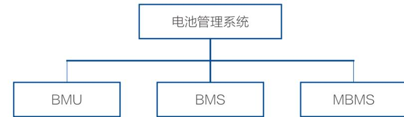
■ MBMS: 将收集所有电池系统状态及参数, 并与 PCS 和 EMS 进行通信调控
