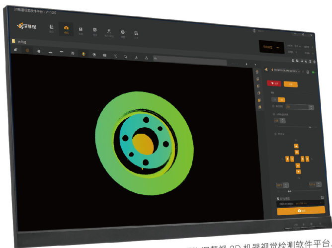
HVS2000生成的反光法兰盘3D伪彩图，界面为深慧视3D机器视觉检测软件平台。
