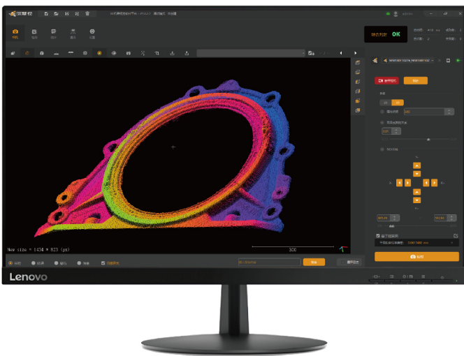
HD2000生成的3D伪彩图，界面为深慧视3D机器视觉检测软件平台。
