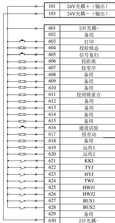
图 4.4.5 光耦插件外部接线图
