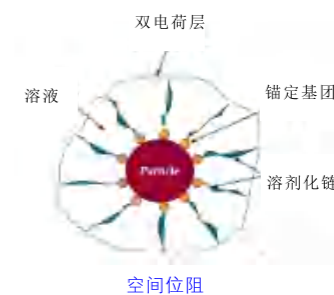
分散剂吸附在颜料粒子表面使其表面带电，并在颜料粒子周围形成双电层，产生相互排斥力
