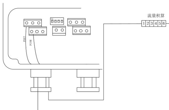
图 4.3 (c) 电子计数器接线
