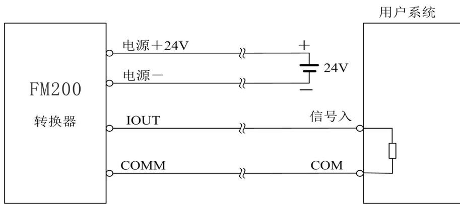
FM200 四线制接线法（供电和电流输出隔离方式）
