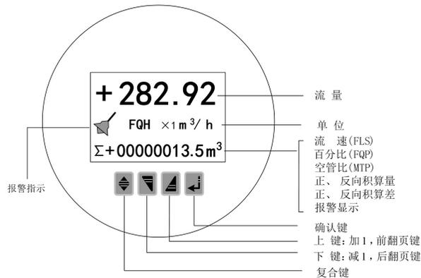
图 4.1 d 圆表键盘定义与液晶显示
