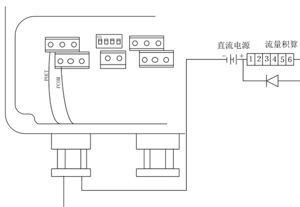
图 4.3 (b) 电磁计数器接线
