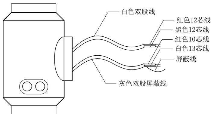
图 4.3 (d) 圆表信号线的处理与标示
