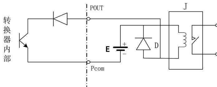
图 4.4 (c) 数字量输出接继电器
