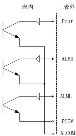
图 4.3 (e) 表内 OC 门连接方式
