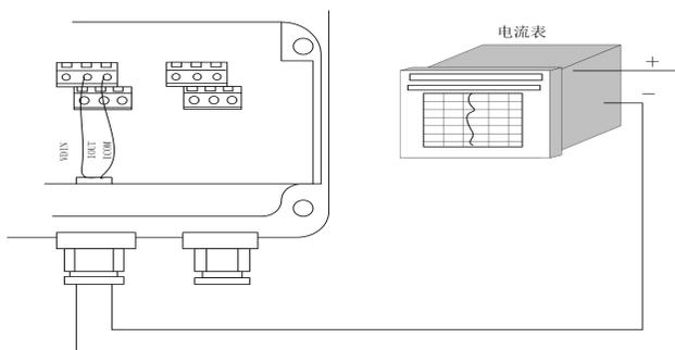
图 4.3 (a) 电流输出接线图
