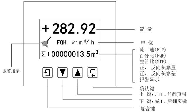
图 4.1 c 方表键盘定义与液晶显示
