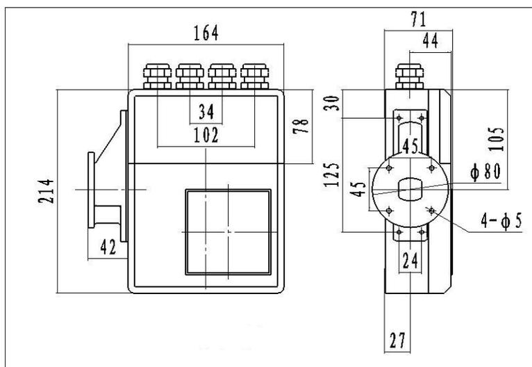
图 2 方型壳体一体式外型尺寸图
