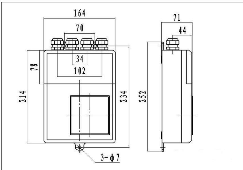
图 3 方型壳体分体式外型尺寸图
