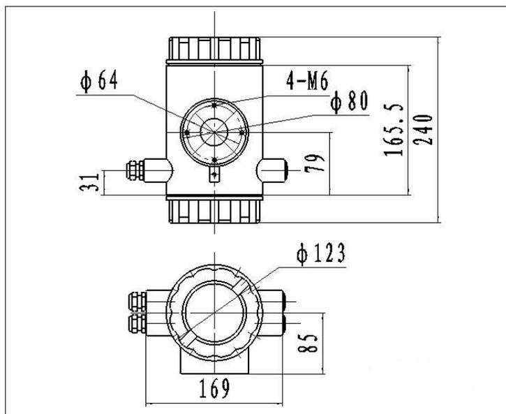
图 1 圆形壳体一体式外型尺寸图
