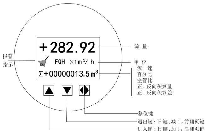
图 4.1 b 圆表键盘定义与液晶显示
