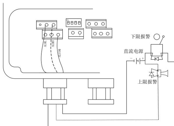
图 4.3 (d) 报警输出接线
