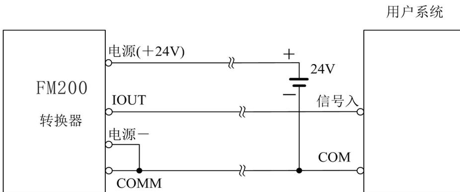
FM200 三线制接线法（供电和电流输出不隔离方式）
