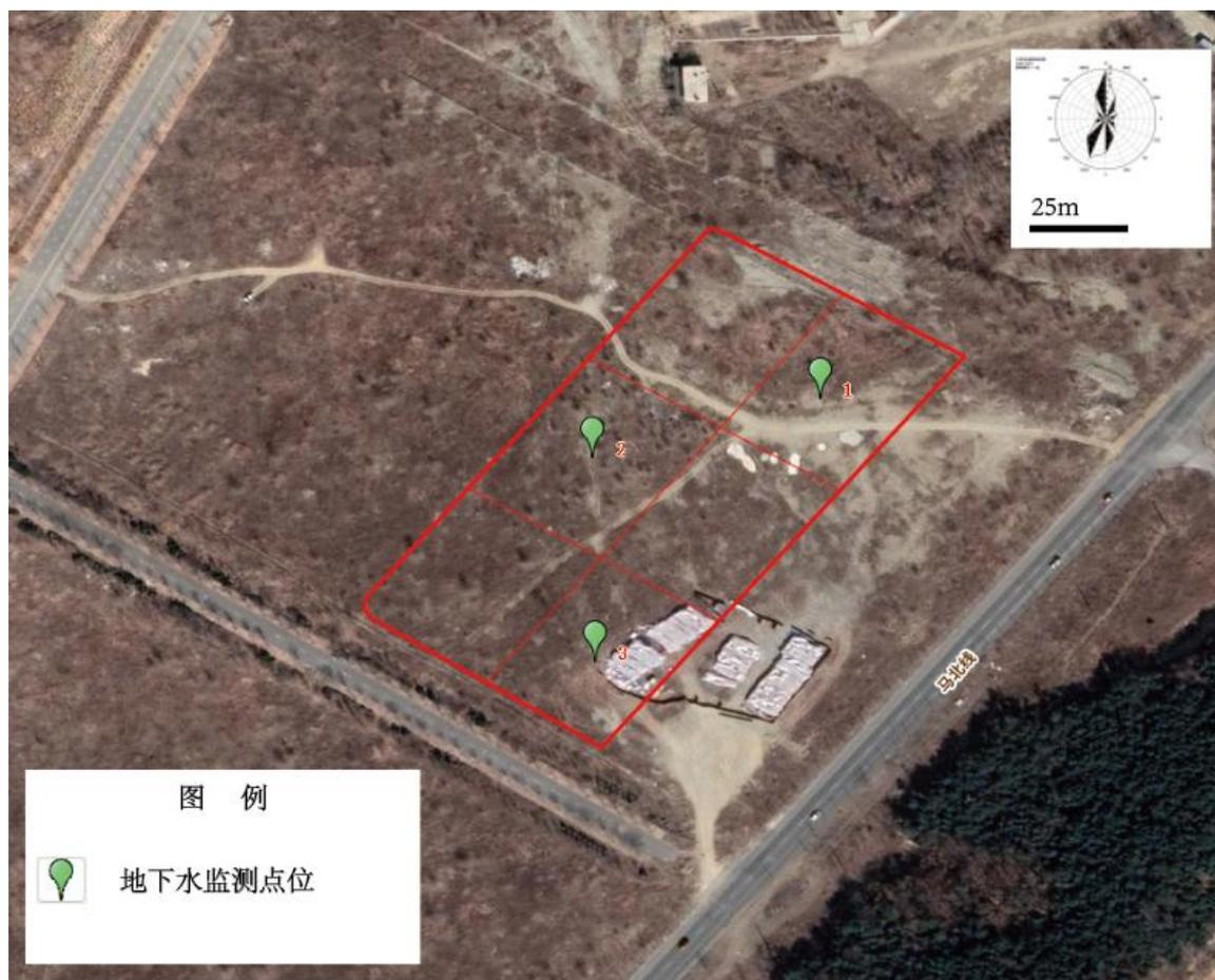
图 7-3 地下水采样监测点位布设图
