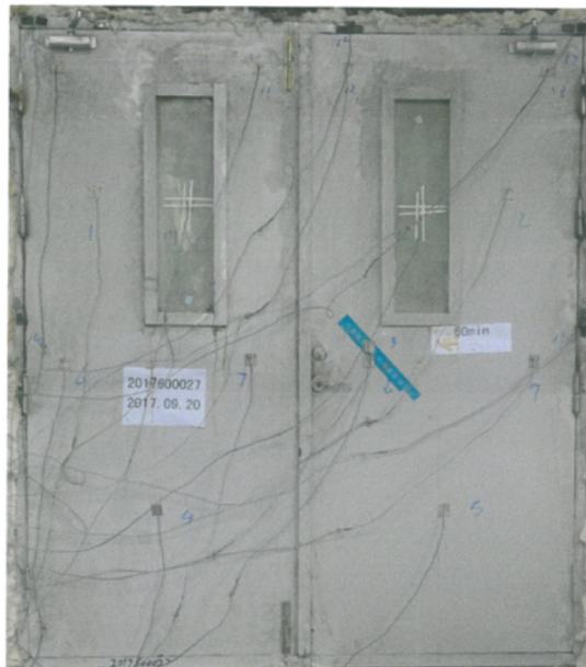
照片 2 耐火试验结束时试件情况
