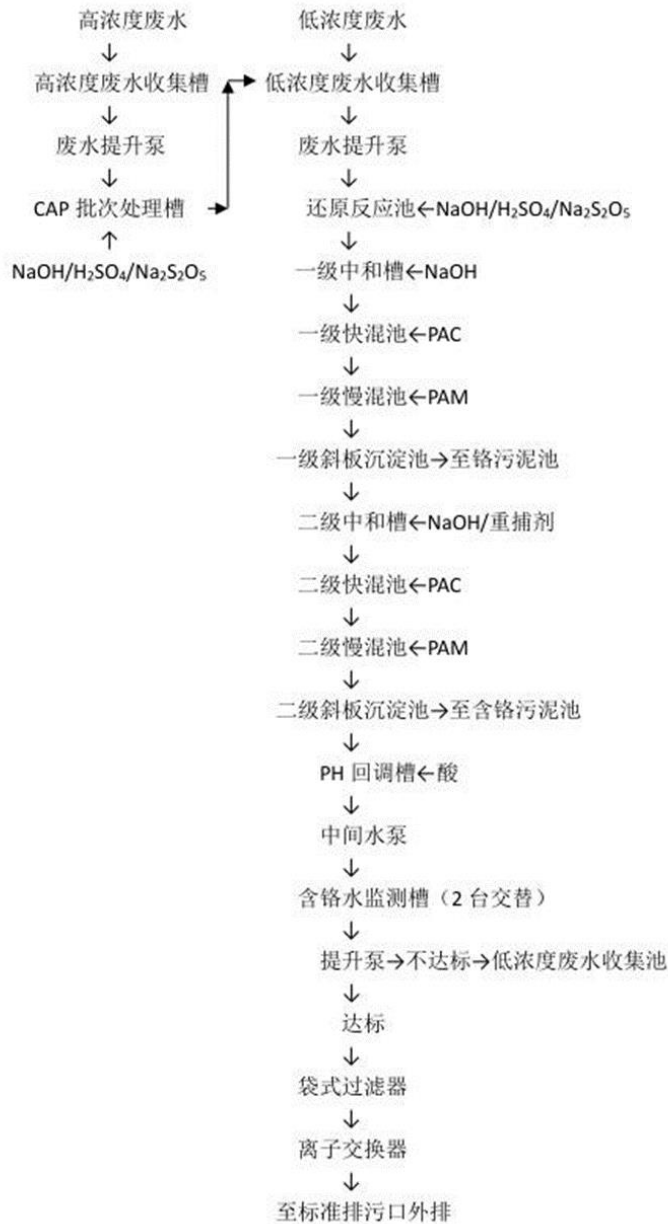
图 3.3.1-3 含铬废水处理站工艺流程图
