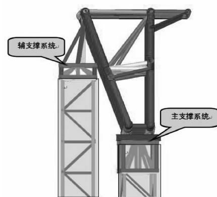
3.2 主桁架下口设置临时组合支撑胎架作为主桁架吊装单元构件吊装临时搁置点,由于主桁架结构为不规则横断面,采用主副支撑系统为一组,共27组54个组临时组合支撑胎架。
