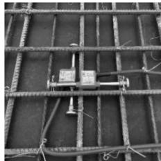
图3 振弦式应变计
