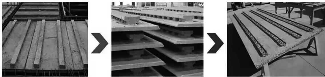
PK板(一代)采用矩形混凝土肋,肋孔为矩形,刚度较大,承载能力较大。
