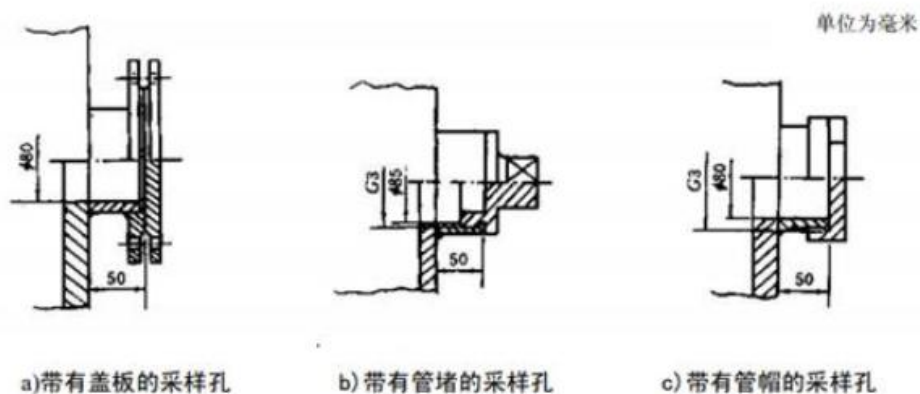
图 4.3-1 封闭形式的采样孔示意图
