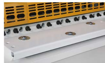
工作台钢球传送结构 Working Table Steel Ball Feeder
