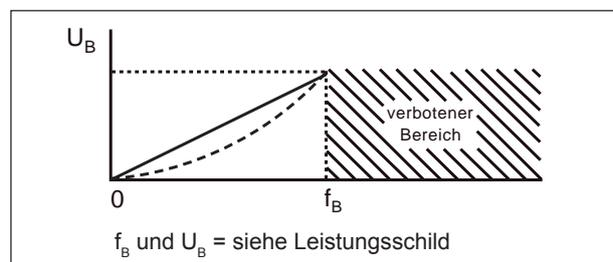
Bei Nichtbeachtung steigt der Motorstrom überproportional an und der Antriebsmotor kommt nicht auf Bemessungsdrehzahl.
