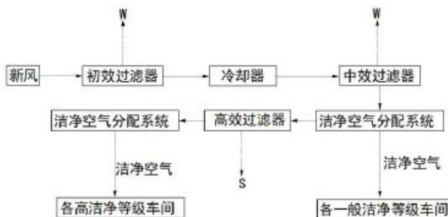
图 3-8 GMP 车间空气净化系统流程图
