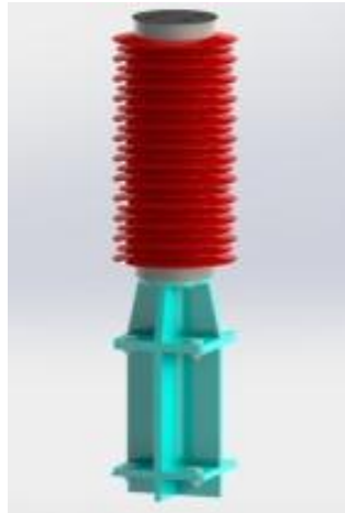
图 7 双隔磁支架安装
