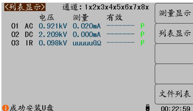
在多步骤测量的情况下，可以清晰的看到每个步骤的测量数据和测量结果。
