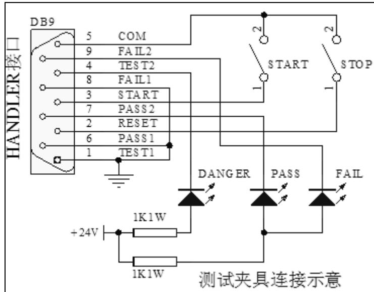
HANDLER 外部电路连接示意图（外接电源）
