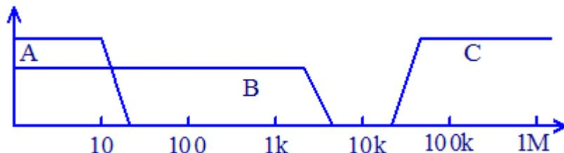
电流超限判断和电弧侦测的频率响应比对：（见上图）
