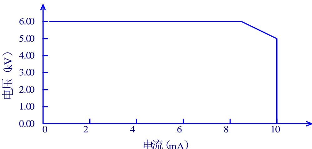
图 3-4 U9053 直流电压输出范围
