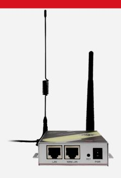
德传CM20 4G/5G RedCap工业路由器,基于3GPP RELEASE 17技术,支持5G SA组网、向下兼容FDD-LTE、TDD-LTE移动宽带 网络,为用户提供稳定可靠的高速络连接与数据传输功能。并支持 两个以太网RJ45接口。
