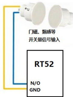
图. 数字开关信号接线图
