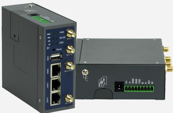
德传R23 4G/5G RedCap工业路由器, 基于3GPP Release 17技术, 支持5G SA组网、向下兼容FDD-LTE、TDD-LTE移动宽带网络, 为用户提供稳定可靠的高速网络连接与数据传输功能。产品提供丰富的数据接口, 包括以太网、RS485、双SIM卡、DIDO等接口。
