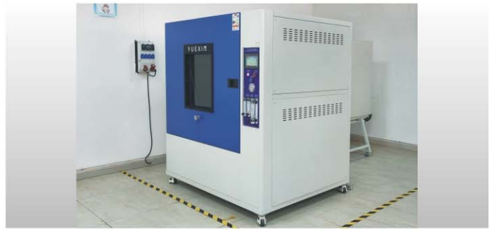
防水测试机 Waterproof Ip Rating Test Chamber 测试产品IPX3-6防水性能
