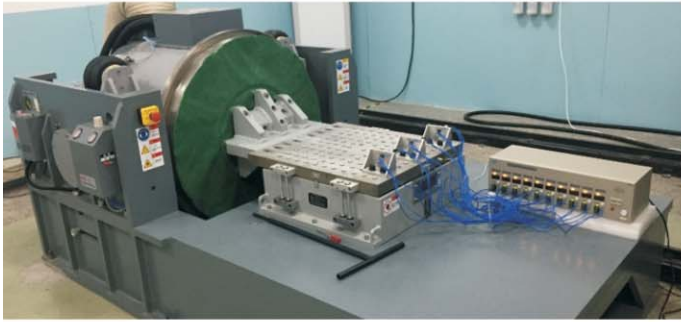
振动测试机 Vibration Test Equipment 测试被测产品在寿命期间耐振动情况
