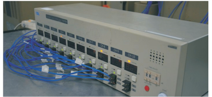
• 电流瞬断测试仪 Electric Current Break Test Equipment 监测被测产品在震动情况下的通电流情况
