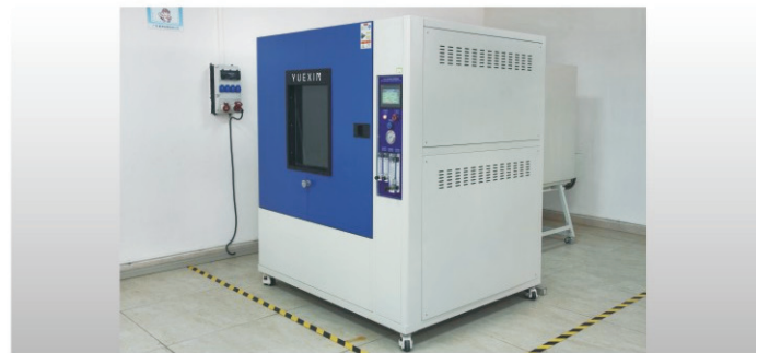
• 防水测试机 Waterproof Ip Rating Test Chamber 测试产品 IPX3-6 防水性能
