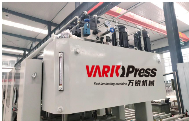
▲万锐压机液压双泵系统
