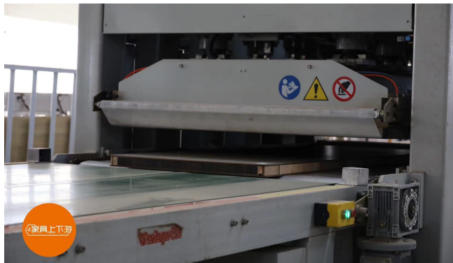
▲万锐AB胶冷压快干压贴产线压合过程
