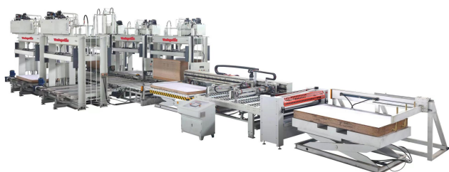
▲万锐木门冷压生产线
