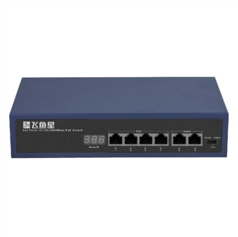
提供“Switch”、“VLAN”和“Extend”三种交换模式，支持三种交换模式一键切换。Switch 模式即标准交换模式，所有端口间能相互通信。VLAN 模式即 VLAN 隔离模式，接入端口间相互隔离，只能与上联端口通信；该模式可有效抑制网络风暴，提高转发效率，使网络安全稳定。Extend 模式即远距离传输模式，
