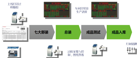
图 4 车间现场终端与电子看板
