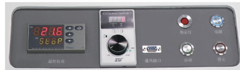
接通空开，打开“开/关”，仪表点亮，散热风扇运行。
