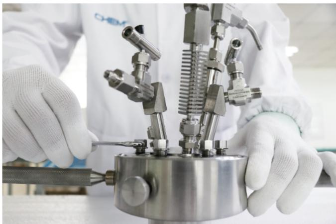
注意：在第一次紧固螺栓时，切勿将某个螺栓过度用力拧紧，以防釜体与釜盖端面不平行，密封圈压紧不均，造成密封失效。
