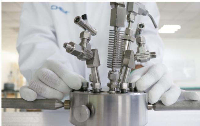
先将卡钳上的六支主螺栓依次手动拧紧（六个螺栓的顺序为 1、2、3、4、5、6），再用配套的扳手，按照 1、4、2、5、3、6 的对角顺序，逐次对角方式，每次拧紧 1/4 圈 -1/3 圈左右，均匀的拧紧，最后用相同的力量按照顺序（1、2、3、4、5、6）检查一遍是否有螺栓没有拧到位，其中要是螺栓在相同力量的情况下能拧动的话，需要再重新拧紧一遍，确保 6 个螺栓用相同的力量都无法拧动即可。
