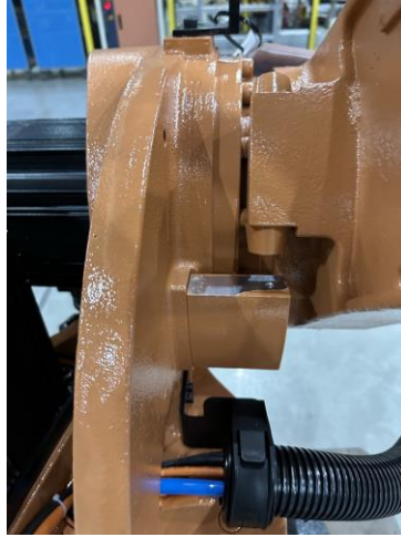
图 4-7 SR70/2180 本体限位块部位检查
