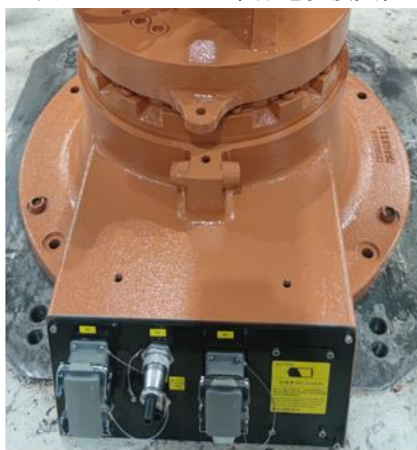
图 4-3 SR70/2180 本体重载连接器检查
