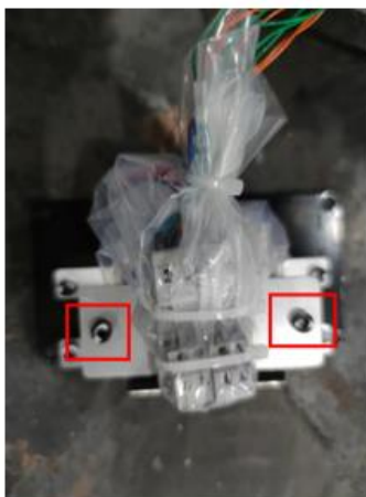
图 4-10 两个固定螺钉位置示意图
