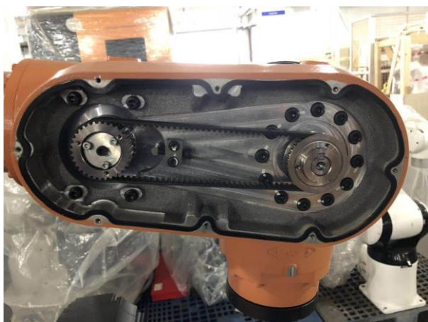
图 4-4 SR70/2180 本体 J5 同步带与带轮检查
