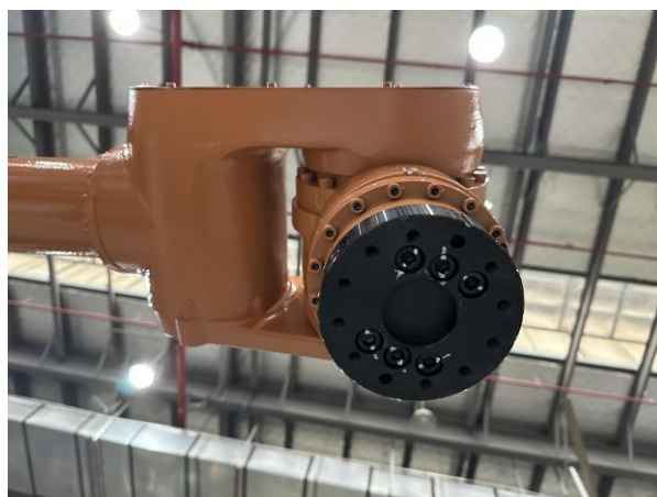
图 4-5 SR70/2180 本体手腕部位检查
