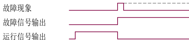
图 7-15 故障信号的时序
