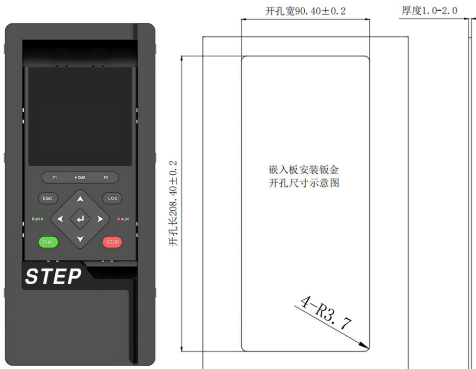
图 2-10 柜门开口尺寸示意图
