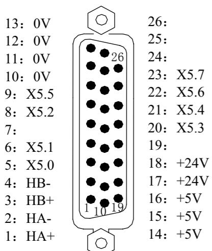
图 2-15 CN31 手轮接口 (26 芯 DB 型针插座)
