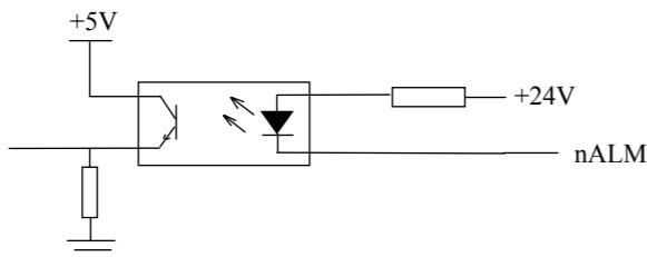
图 2-3 驱动单元报警信号内部电路
