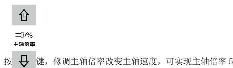
按 键，修调主轴倍率改变主轴速度，可实现主轴倍率 50% ~ 120% 共 8 级实时调节。
