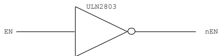
图 2-5 轴使能信号内部接口电路
