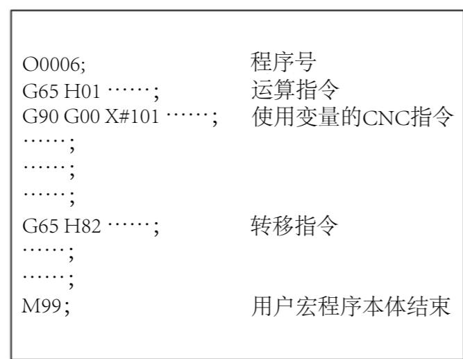
图 3-7-1-2 ( 用户宏程序本体的构成 )
