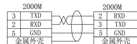
图 2-23B 2000M 通信的连接
