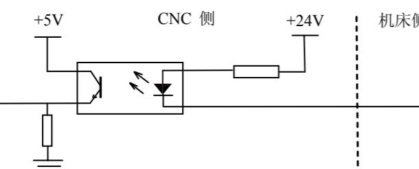
图 2-19 PC5 信号电路
