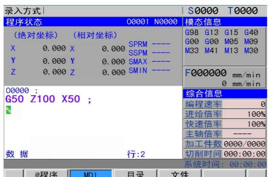
按 **循环启动** 键执行输入的程序段。运行过程中可按 **进给保持** 键、**RESET //** 键以及急停按钮使程序段停止运行。
