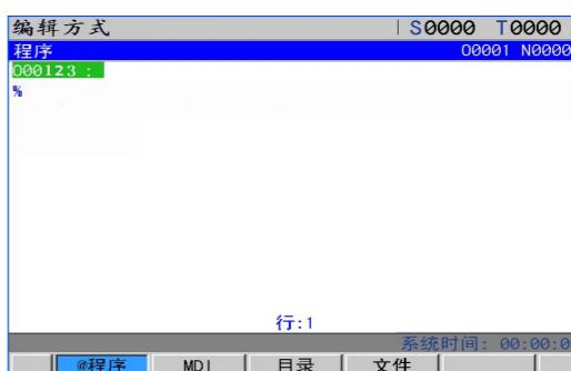
4) 按照编制好的零件程序逐个输入，每输入一个字符，在屏幕上立即给予显示输入的字符（复合键的处理是反复按此复合键，实现交替输入），完成后需切换到其它工作方式将程序存储起来。
