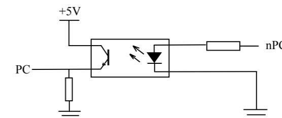
图 2-7 零点信号电路
