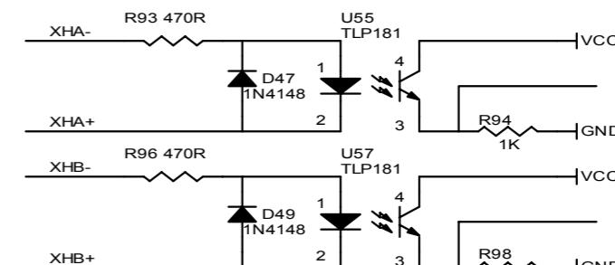
图 2-16 手轮信号电路
