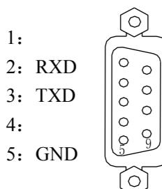
图 2-22 CN51 通信接口 (9 孔)
