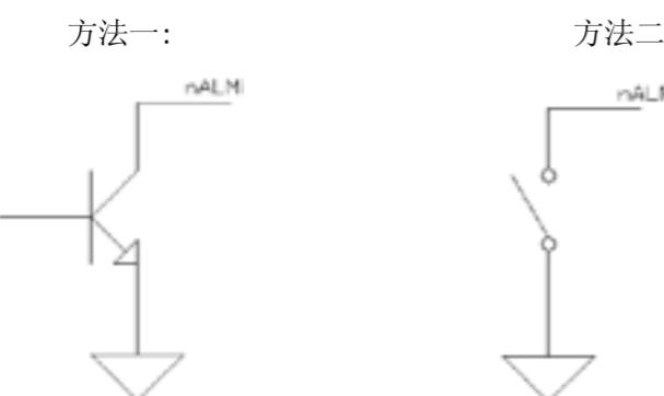
图 2-4 驱动单元提供信号的方式
