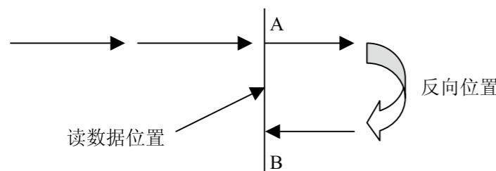
图 4-4 反向间隙测量方法示意图
