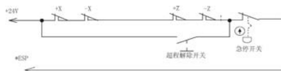
当出现硬件超程，2000M 会出现“急停”报警。消除“急停”报警的方法为：按下超程解除按钮不松开，切换到报警信息页面，查看报警信息后，复位清除报警后，反方向移动工作台（如正向超程，则负向移出；如负向超程，则正向移出）脱离行程开关。
