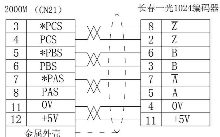
图 2-14 2000M 与编码器的连接
