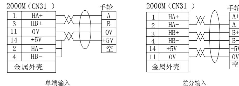
图 2-17 2000M 与手轮的连接
