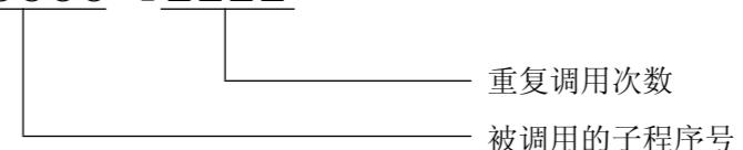
**代码功能：** 在自动方式下，执行 M98 代码时，当前程序段的其它代码执行完成后，CNC 去调用执行 P 指定的子程序，子程序最多可执行 9999 次。M98 代码在 MDI 下运行无效。
