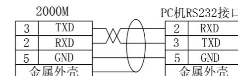
图 2-23A 2000M 与 PC 机的连接
