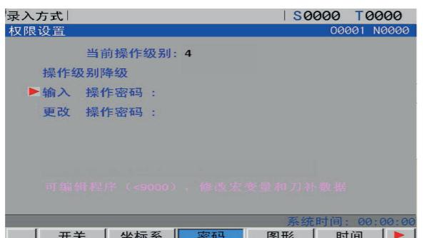
移动光标至“输入操作密码”行，输入 12345，按 键，CNC 提示“可修改参数，可编辑程序。”、“密码通过”，当前操作级别改为 3 级。显示页面如下：
