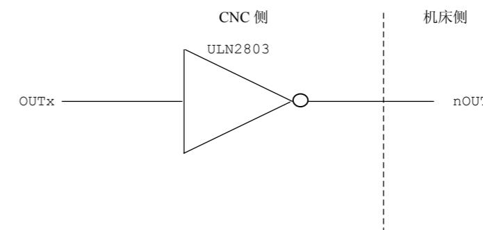
图 2-29 数字量输出模块电路结构图
