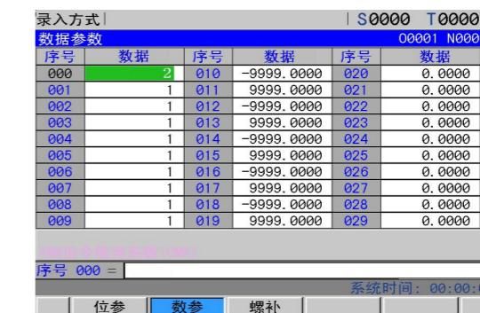
示例 2: 将螺补数据 № 000 的 X 轴的数值设置为 12, Z 轴的数值设置为 30。按上述步骤将光标移至螺补数据 № 000 上, 在提示行中依次键入 X12。
