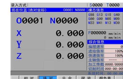
注：在编辑、自动、录入、显示“编程速度”；在机床回零、程序回零、手动方式下显示“手动速度”。在手轮方式下显示“手轮增量”；在单步方式下显示“单步增量”。
