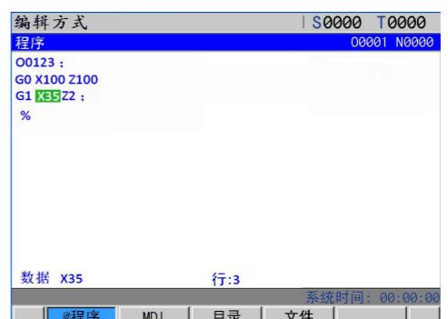
2、如当前光标所在程序段的模态 (G、M、T、F 代码) 缺省，并与运行该程序段的模态不一致，必须执行相应的模态功能后方可继续下一步骤；
