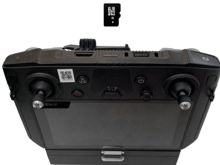
打开遥控器电源，无人机电源，启动后将遥控器连接可靠的 WIFI 或手机热点。
