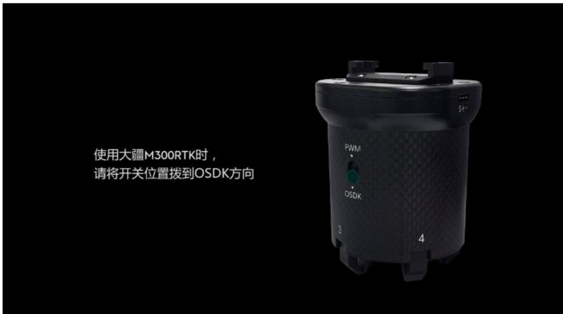
当客户需要使用第三方无人机时，可使用外置接收机或 PWM 信号线连接 5 段投放器的 PWM 接口，接口规格为杜邦 2.54mm 3P，注意外壳接线定义，该接口提供了 5V2A 的直流电源，识别信号频率为 1.0ms ~ 2.0ms 50HZ 两档开关信号，不可使用高于 5V 的电压连接此接口。
