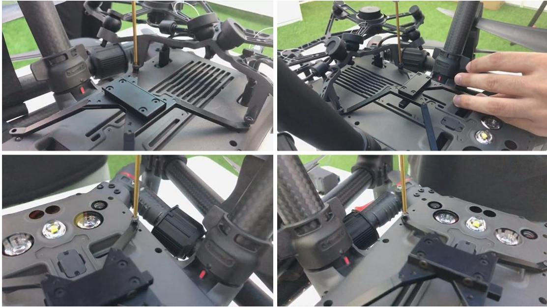
将五段投放器安装至快拆挂架卡口，对准后推入，听到咔声后表示锁紧，可以晃动投放器，确认安装是否牢固。
