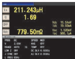
L,Q,Rdc连续测量界面 L, Q(1kHz, CC1mA测量)和 Rdc(DC测量)的显示界面
