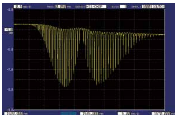
氨化氢 \text{H}_{13}\text{C}_{14}\text{N} 的吸收光谱测量(AQ6375B)
